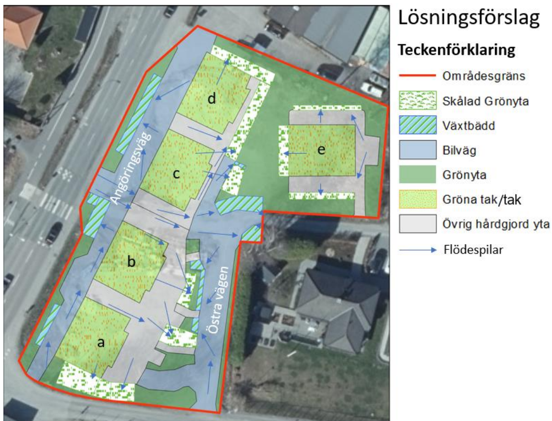
Figur 19. Förslag på placering av lösningar samt flöden (lösningar är skalenliga storleksmässiga men är uppdelade och placerade utan hänsyn till höjdsättning).
